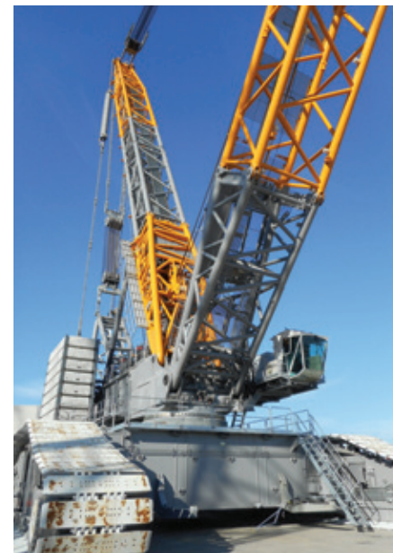
Una LR 13000, la mayor grúa sobre orugas convencional, está operando en el proyecto de la refinería Miguel Hidalgo, en México.
