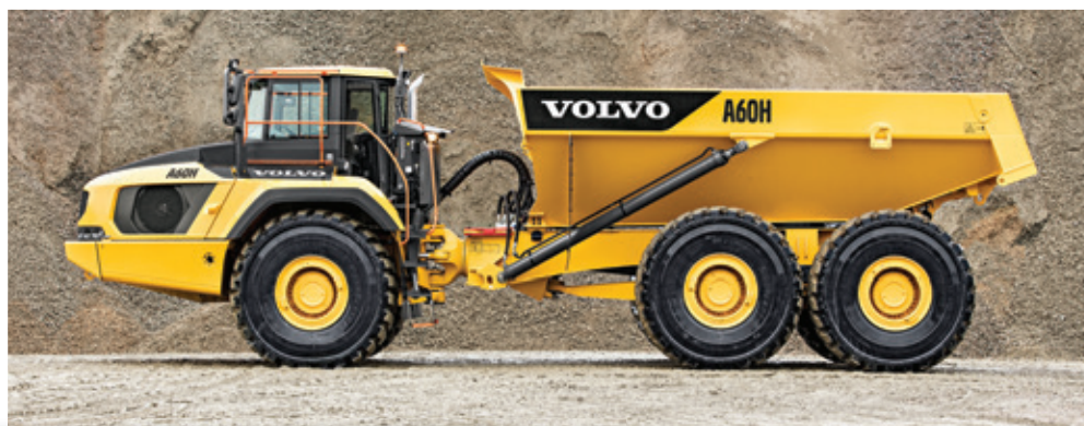
Con motor Volvo de 669 HP, el A60H tiene control automático de tracción y verificación digital del peso de carga.
