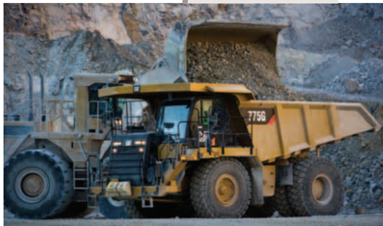
Caterpillar exhibió un camión 775G que desde el año pasado está operando con un motor que cumple con las exigencias impuestas por la Tier 4 Final.
